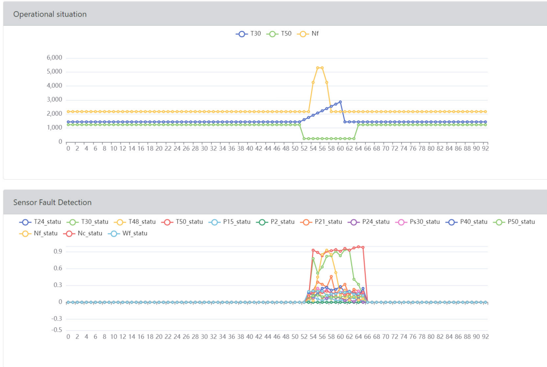
图 5.10 仿真实例传感器故障诊断结果（Web 端）
